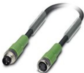
Sensor-/Aktor-Kabel, 3-polig, PUR halogenfrei, schwarzgrau RAL 7021, Stecker gerade M8, auf Buchse gerade M8, Kabellänge: 1,5 m
