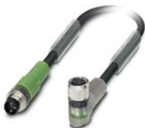
Sensor-/Aktor-Kabel, 3-polig, PUR halogenfrei, schwarzgrau RAL 7021, Stecker gerade M8, auf Buchse gewinkelt M8, mit 2 LEDs, Kabellänge: 1,5 m
