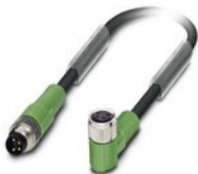
Sensor-/Aktor-Kabel, 4-polig, PUR halogenfrei, schwarzgrau RAL 7021, Stecker gerade M8, auf Buchse gewinkelt M8, Kabellänge: 3 m
