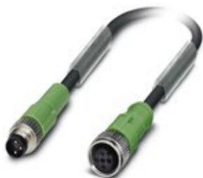
Sensor-/Aktor-Kabel, 3-polig, PUR halogenfrei, schwarzgrau RAL 7021, Stecker gerade M8, auf Buchse gerade M12, Kodierung: A, Kabellänge: 1,5 m
