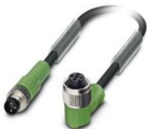
Sensor-/Aktor-Kabel, 3-polig, PUR halogenfrei, schwarzgrau RAL 7021, Stecker gerade M8, auf Buchse gewinkelt M12, Kodierung: A, Kabellänge: 1,5 m
