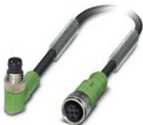
Sensor-/Aktor-Kabel, 3-polig, PUR halogenfrei, schwarzgrau RAL 7021, Stecker gewinkelt M8, Kodierung: A, auf Buchse gerade M12, Kodierung: A, Kabellänge: 0,3 m
