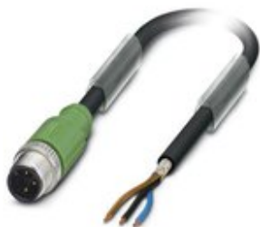
Sensor-/Aktor-Kabel, 3-polig, PUR halogenfrei, schwarzgrau RAL 7021, geschirmt, Stecker gerade M12, Kodierung: A, auf freies Leitungsende, Kabellänge: 3 m
