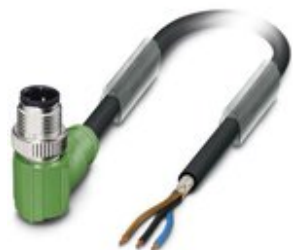
Sensor-/Aktor-Kabel, 3-polig, PUR halogenfrei, schwarzgrau RAL 7021, geschirmt, Stecker gewinkelt M12, Kodierung: A, auf freies Leitungsende, Kabellänge: 3 m
