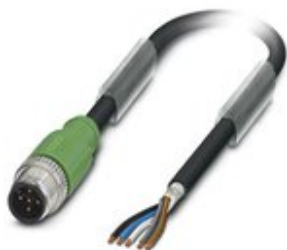
Sensor-/Aktor-Kabel, 5-polig, PUR halogenfrei, schwarzgrau RAL 7021, geschirmt, Stecker gerade M12, Kodierung: A, auf freies Leitungsende, Kabellänge: 3 m
