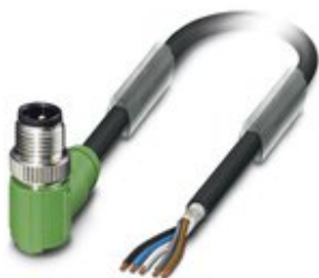
Sensor-/Aktor-Kabel, 5-polig, PUR halogenfrei, schwarzgrau RAL 7021, geschirmt, Stecker gewinkelt M12, Kodierung: A, auf freies Leitungsende, Kabellänge: 3 m
