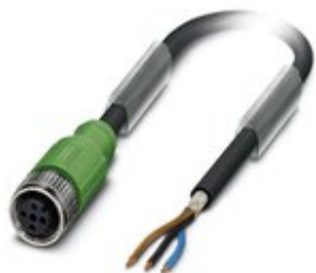
Sensor-/Aktor-Kabel, 3-polig, PUR halogenfrei, schwarzgrau RAL 7021, geschirmt, freies Leitungsende, auf Buchse gerade M12, Kodierung: A, Kabellänge: 1,5 m
