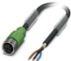
Sensor-/Aktor-Kabel, 3-polig, PUR halogenfrei, schwarzgrau RAL 7021, geschirmt, freies Leitungsende, auf Buchse gerade M12, Kodierung: A, Kabellänge: 5 m
