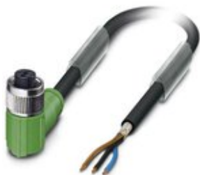
Sensor-/Aktor-Kabel, 3-polig, PUR halogenfrei, schwarzgrau RAL 7021, geschirmt, freies Leitungsende, auf Buchse gewinkelt M12, Kodierung: A, Kabellänge: 5 m
