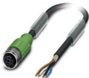
Sensor-/Aktor-Kabel, 4-polig, PUR halogenfrei, schwarzgrau RAL 7021, geschirmt, freies Leitungsende, auf Buchse gerade M12, Kodierung: A, Kabellänge: 3 m
