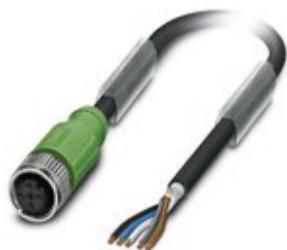
Sensor-/Aktor-Kabel, 5-polig, PUR halogenfrei, schwarzgrau RAL 7021, geschirmt, freies Leitungsende, auf Buchse gerade M12, Kodierung: A, Kabellänge: 1,5 m
