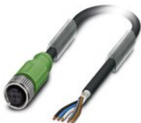
Sensor-/Aktor-Kabel, 5-polig, PUR halogenfrei, schwarzgrau RAL 7021, geschirmt, freies Leitungsende, auf Buchse gerade M12, Kodierung: A, Kabellänge: 5 m
