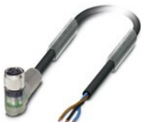
Sensor-/Aktor-Kabel, 3-polig, PUR halogenfrei, schwarzgrau RAL 7021, freies Leitungsende, auf Buchse gewinkelt M8, mit 2 LEDs, Kabellänge: 10 m
