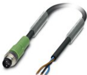
Sensor-/Aktor-Kabel, 3-polig, PUR halogenfrei, schwarzgrau RAL 7021, Stecker gerade M8, auf freies Leitungsende, Kabellänge: 10 m
