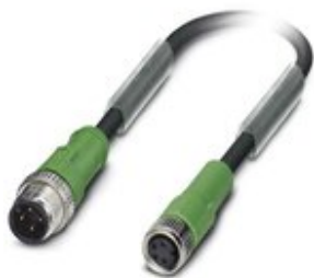
Sensor-/Aktor-Kabel, 4-polig, PUR halogenfrei, schwarzgrau RAL 7021, Stecker gerade M12, Kodierung: A, auf Buchse gerade M8, Kabellänge: 3 m
