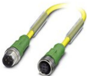
Sensor-/Aktor-Kabel, 4-polig, PUR/PVC, gelb, Stecker gerade M12, Kodierung: A, auf Buchse gerade M12, Kodierung: A, Kabellänge: 0,3 m, DESINA
