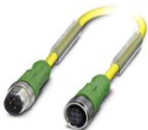
Sensor-/Aktor-Kabel, 4-polig, PUR/PVC, gelb, Stecker gerade M12, Kodierung: A, auf Buchse gerade M12, Kodierung: A, Kabellänge: 0,6 m, DESINA
