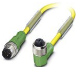
Sensor-/Aktor-Kabel, 4-polig, PUR/PVC, gelb, Stecker gerade M12, Kodierung: A, auf Buchse gewinkelt M12, Kodierung: A, Kabellänge: 1,5 m, DESINA
