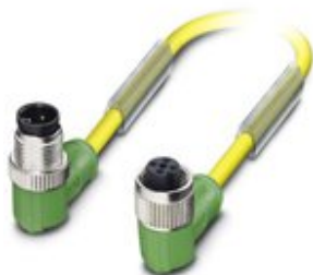
Sensor-/Aktor-Kabel, 4-polig, PUR/PVC, gelb, Stecker gewinkelt M12, Kodierung: A, auf Buchse gewinkelt M12, Kodierung: A, Kabellänge: 0,3 m, DESINA
