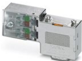
D-SUB-Stecker, 9-polig, Stift, Kabelzuführung unter 90°, Bussystem: PROFIBUS DP bis 12 MBit/s, Abschlusswiderstand über Schiebeschalter zuschaltbar, Pinbelegung: 3, 5, 6, 8; IDC-Klemmenanschluss
