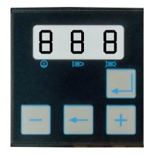
Alle Einstellungen am MPA 41xx Gasfeuerungsautomaten können auch mittels Laptop / PC über die MPA Vision Box vorgenommen werden.
