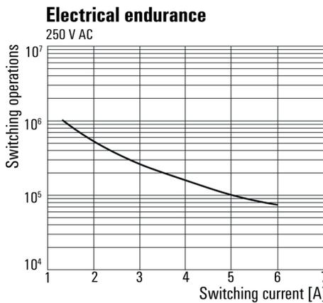
Elektrische Lebensdauer 230 V AC resistive load
