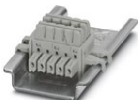
Tragschienen-Busverbinder (TBUS), 5-polig, zur Brückung der Versorgungsspannung, aufsteckbar auf Tragschiene NS 35/... nach EN 60715
