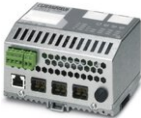
Ethernet Switch, einem Port im RJ45-Format und drei Ports im POF SC-RJ-Format für PROFINET RT/IRT, tragschienenmontabel
