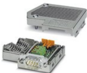
D-SUB-Stecker, 9-polig, Stift, zwei Kabelzuführungen unter 35°, Bussystem: PROFIBUS DP bis 12 MBit/s, Abschlusswiderstand über Schiebeschalter zuschaltbar, Pinbelegung: 3, 5, 6, 8; Federkraftanschlussklemmen
