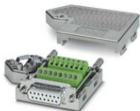
D-SUB-Stecker, 15-polige Buchse, eine Kabelzuführung unter 35°, Universaltyp für alle Systeme, Pinbelegung: 1, 2, 3, ..., 14, 15 auf Schraubanschlussklemme
