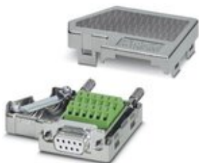
D-SUB-Stecker, 9-polige Buchse, zwei Kabelzuführungen unter 35°, Bussystem: CANopen, FIP, Pinbelegung: 2, 3, 6, 7, 8, 9 auf je zwei Schraubanschlussklemmen
