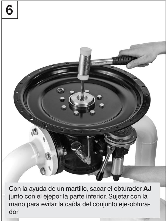
Con la ayuda de un martillo, sacar el obturador **AJ** junto con el eje por la parte inferior. Sujetar con la mano para evitar la caída del conjunto eje-obturador
