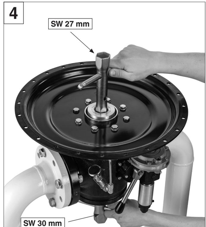
Aflojar la tuerca R con una llave de tubo SW 27 mm sujetando por el extremo inferior el obturador con una llave de tubo SW 30 mm.
