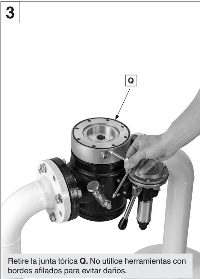
Retire la junta tórica **Q**. No utilice herramientas con bordes afilados para evitar daños.
