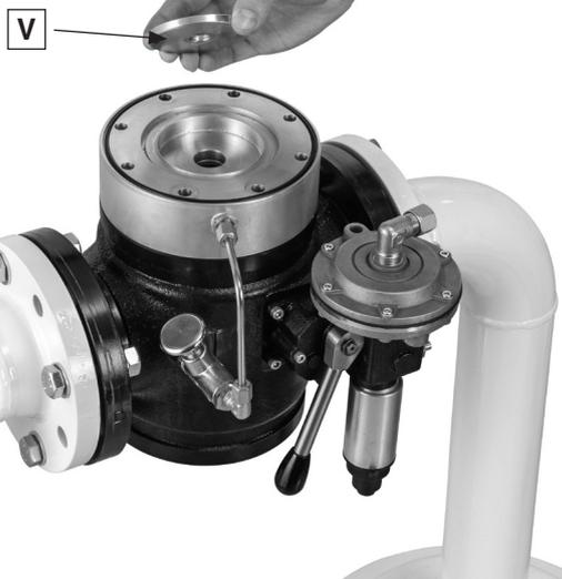
Retirar el disco inferior de la membrana de compensación V bajo la membrana de compensación T.
