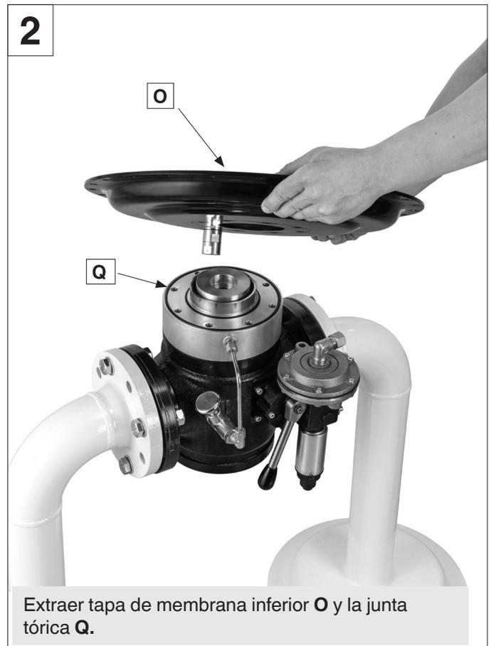
Extraer tapa de membrana inferior **O** y la junta tórica **Q**.
