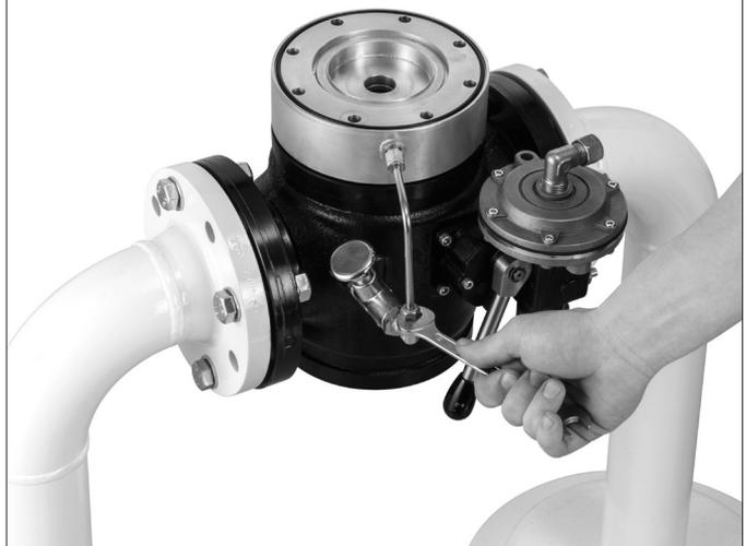
Retirar tubing de bypass con llave SW 14 mm.
