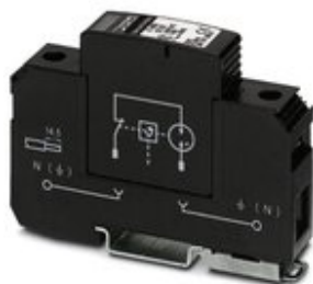
Überspannungsableiter Typ 2, bestehend aus Basiselement und Schutzstecker mit N-PE-Summenstromfunkenstrecke, zur Montage auf NS 35/7,5. Gehäusebreite: 17,5 mm (1TE)
