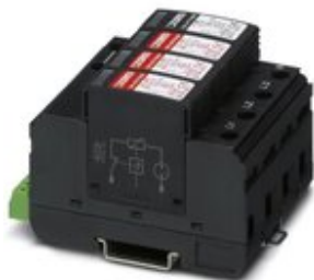
Überspannungsableiter 4-kanalig, zur Montage auf NS 35/7,5, mit Fernmeldekontakt. 350 V AC
