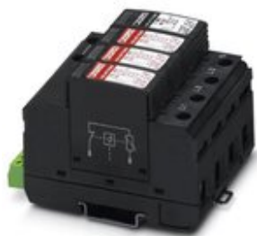
Überspannungsableiter 4-kanalig, zur Montage auf NS 35/7,5, mit Fernmeldekontakt (FM) als Wechsler, Spannung 230 V AC
