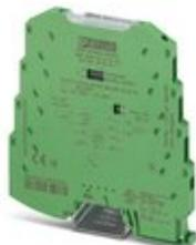
MCR-3-Wege-Trennverstärker, mit konfigurierbarem Ein-/Ausgang, zur galvanischen Trennung und Wandlung von Analogsignalen bis 30 V mit Schraubanschluss, Standardkonfiguration
