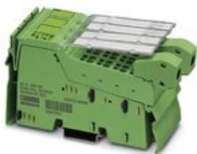
Inline-Analog-Dehnmessstreifen-Eingabeklemme, komplett mit Zubehör (Anschlussstecker und Beschriftungsfeld), 2 schnelle Eingänge, 4-, 6-Leiter-Anschlussstechnik
