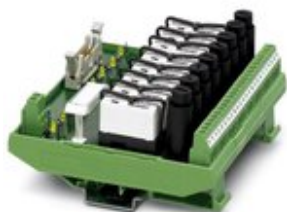
VARIOFACE-Ausgabemodul, mit 8 Miniaturrelais, je 1 Wechsler und Sicherung, gesteckt, für 24 V DC (inkl. Relais)
