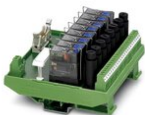
VARIOFACE-Ausgabemodul, mit 8 Miniaturrelais, je 1 Wechsler mit feststellbarer Handbetätigung und Sicherung, gesteckt, für 24 V DC (inkl. Relais)
