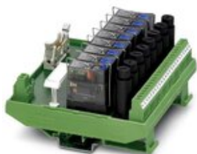
Moduł wyjściowy VARIOFACE z 8 miniaturowymi przekaźnikami, 1 stykiem przełącznym z nastawnym uruchomieniem ręcznym i bezpiecznikiem, wtykanym, na 24 V DC (wraz z przekaźnikami)
