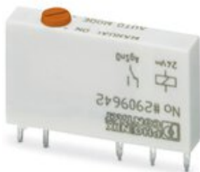
Steckbares Miniaturleistungsrelais, mit Leistungskontakt, 1 Wechsler, Handbetätigung, Eingangsspannung 24 V DC
