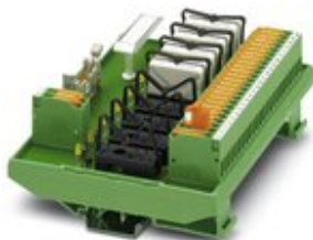
VARIOFACE-Ausgabemodul, mit Stecksockeln für 8 Miniaturrelais, je 1 Wechsler, für 24 V DC, mit Messer-Trennklemmen im Ausgang (ohne Relais)
