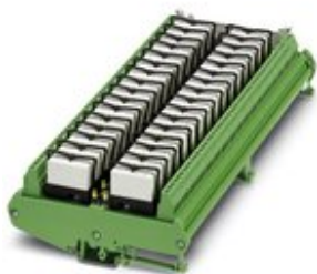
VARIOFACE-Ausgabemodul, mit 32 Miniaturrelais, 1 Wechsler, gesteckt, für 24 V DC (inkl. Relais)
