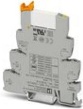
PLC-INTERFACE, bestehend aus Grundklemme PLC-BSC.../21 mit Schraubanschluss und steckbarem Miniaturrelais mit Mehrlagen-Goldkontakt, zur Montage auf Tragschiene NS 35/7,5, 1 Wechsler, Eingangsspannung 125 V DC
