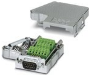
D-SUB-Stecker, 15-polig, zwei 35°-Kabeleinführungen, Universaltyp für alle Systeme, Pinbelegung: 1, 2, 3, ..., 14, 15 auf Schraubanschlussklemme
