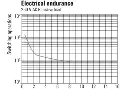
Elektrische Lebensdauer 250 V AC resistive load 250 V AC ohmsche Last
