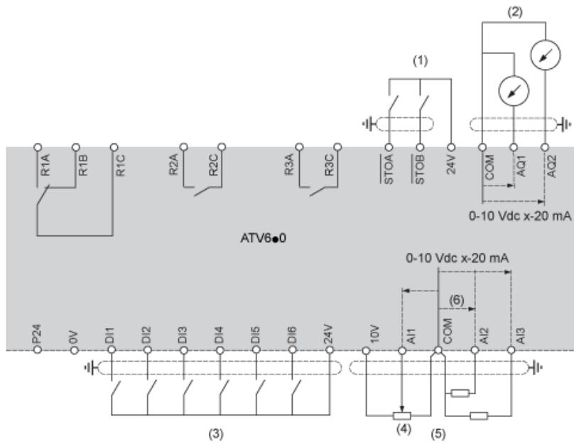
(1) Safe Torque Off: sicher abgeschaltetes Drehmoment
