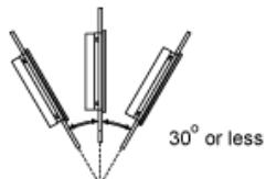
Bei Montage dieses Produkts in schräger Position mit einer Neigung von mehr als 30° darf die Umgebungstemperatur nicht höher sein als 40 °C (104 °F). Gegebenenfalls müssen Sie eine Gebläseluftkühlung (Ventilator, Klimaanlage) einsetzen, damit eine Umgebungsbetriebstemperatur von höchstens 40 °C (104 °F) gewährleistet ist.
