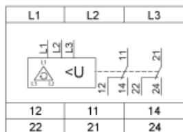
L1,L2,L3: Zu überwachende Spannung
