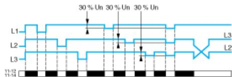
Überwachung auf Unterspannung
