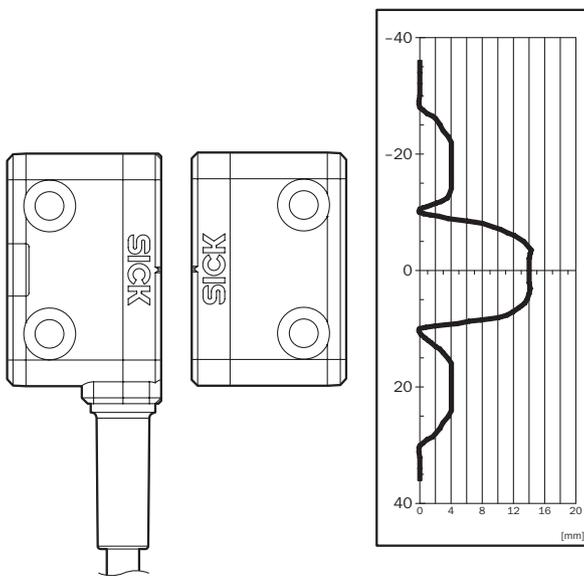
Gesicherter Einschaltabstand  $S_{ao}$  10 mm. Randbereiche bei paralleler Annäherung beachten: Wenn sich der Betätiger seitlich zur Sensorfläche bewegt, muss ein Mindestabstand von 6 mm (typisch) eingehalten werden. Dies verhindert ein zu frühzeitiges Auslösen aufgrund der seitlichen Ansatzbereiche.
